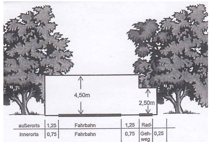
Über den Fahrbahnen ist ein Bereich von 4,50 m Höhe und über den
